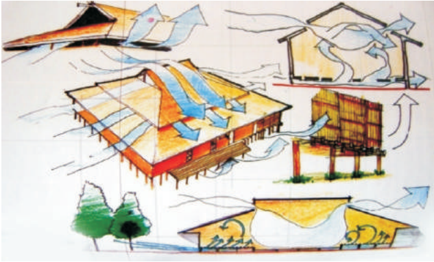
Gambar 18. Sirkulasi Udara pada Rumah Adat Balai (Sumber: Muchammad, 2007)
